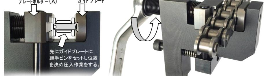
2)カット&リベット用ピンが継手ピン(カシメ)に接するところまでプッシャーボルトを手で回して下さい。カシメ作業は、メガネレンチでプッシャーボルトを時計回転方向に回しピンかきめを行って下さい。
